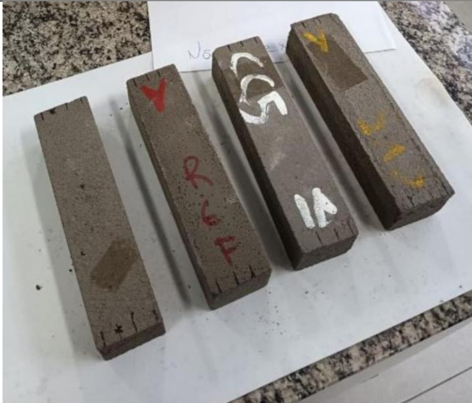
Figura 05: Corpos de prova submetidos a ataque por sulfatos
