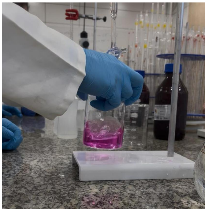
Figura 02: Ensaio de acidez por titulometria sendo realizada na disciplina de Qualidade Sanitária da Água
