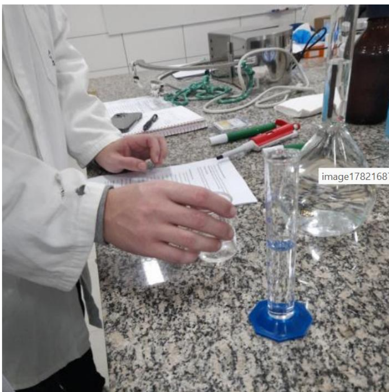
Figura 03: Preparação de branco amostral pra análise da demanda química de oxigênio, na disciplina de Qualidade Sanitária da Água
