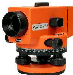
**Nível automático (FOIF DSZ3-A32):** Utilizado para medir e nivelar alturas.
