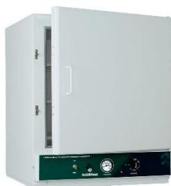
**Estufa de esterilização e secagem analógica (SolidSteel):** Utilizado para secar amostras de terra.
