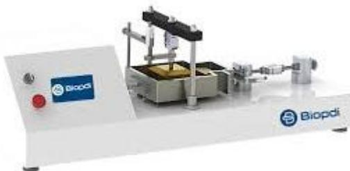
**Ensaio de cisalhamento ():** Utilizado para determinar a resistência ao corte de uma amostra de solo.
