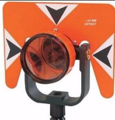
**Prisma circular (FOIF):** Utilizado para medir distâncias e fazer levantamentos de terrenos.
