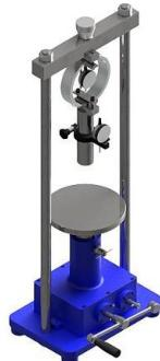
**Prensa para ensaio CBR (I-1006):** Utilizado para realização do ensaio de determinação do CBR, o ensaio tem por finalidade determinar a resistência à penetração em solos.
