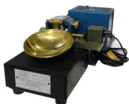
**Aparelho Casagrande elétrico com contador de golpes (I-1002-D):** Utilizado para determinar o limite de liquidez e plasticidade dos solos.
