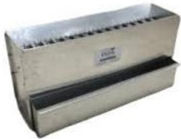
**Repartidor de amostras:** Utilizado para dividir em duas partes a amostra que nele for lançada, distribuindo o material em duas bandejas.
