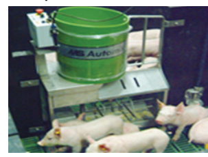
Comedouro de fornecimento e umedecimento automatizado
