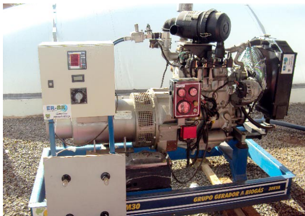
Figura 1. Gerador de energia elétrica acionado com motor que utiliza biogás como combustível.
