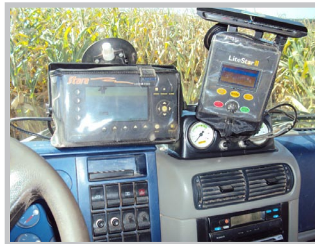
Caminhão com equipamentos para aplicação de corretivos nas lavouras utilizando GPS. Detalhe do painel com instrumentos de operação (fotos CDA 2010).
