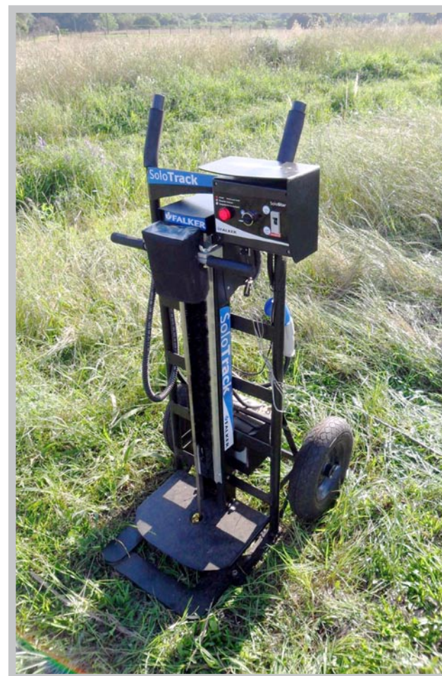
Figura 1. Vista do equipamento "Solo Track" avaliando a resistência do solo à penetração nos experimentos conduzidos pelo CEO/UDESC, em Chapecó, SC.
