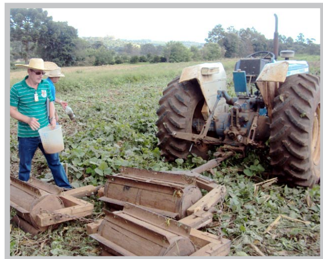
Detalhe do equipamento rolo-faca que ao tempo que fez o acamamento da crotalaria (adubação verde de verão) que se desenvolveu após a colheita do milho, incorporou na palhada, as sementes de ervilhaca (adubação verde de inverno), sem a utilização de herbicida.
