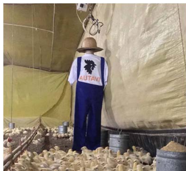
Figura 1: Imagem do Robô utilizado para a estimulação dos pintinhos
