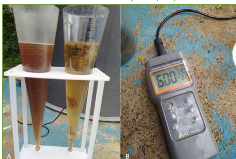
Figura 1 - Testes de coagulação no efluente do lavador de gases. A: Efluente sem e com produtos adicionados. B: medição de pH após teste.
