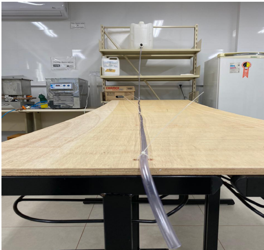
Figura 1 – Experimento de DTR montado no laboratório de ensino.
