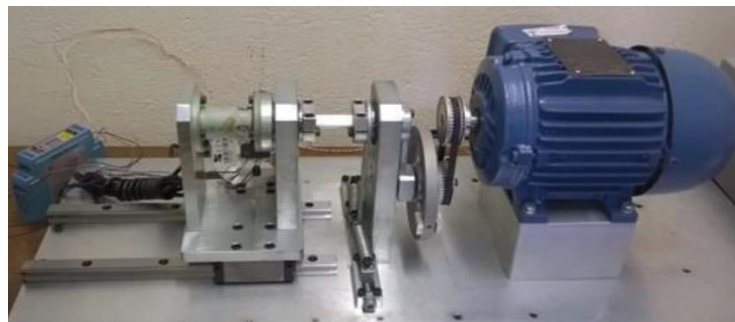
Figura 1 - Máquina de Fadiga para Torção Baseada em Desbalanceamento Rotativo.
