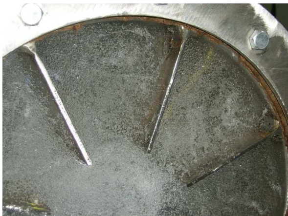
Figura 3. Foto frontal do equipamento de ensaio de erosão por cavitação, com a formação das bolhas.
