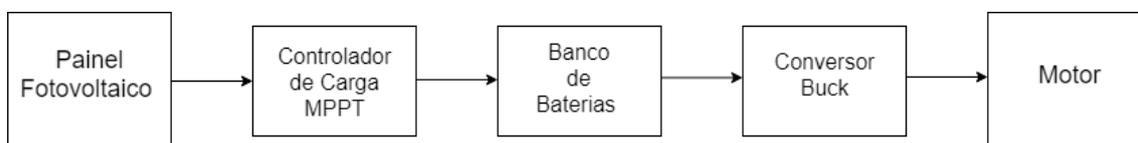
**Figura 2 - Diagrama de blocos do sistema elétrico**
