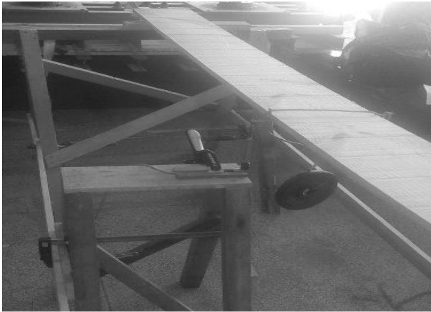
Figura 2. Ensaio de flexão para determinação do módulo de elasticidade das tábuas.
