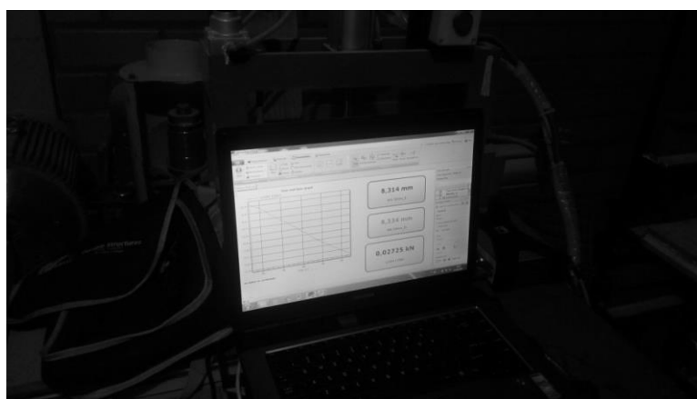
Figura 8. Imagem do monitor durante uso do programa HBM Catman Easy para leitura da carga e do deslocamento durante o ensaio de flexão.
