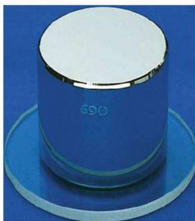
Figura 1-3 O quilograma-padrão internacional de massa, um cilindro de platina-irídio com 3,9 cm de altura e 3,9 cm de diâmetro. (Cortesia do Bureau Internacional de Pesos e Medidas, França)
