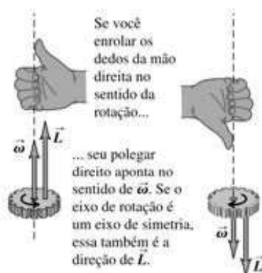
Figura 10.26 Para a rotação em torno de um eixo de simetria, \vec{\omega} e \vec{L} são vetores paralelos e estão sobre o eixo de simetria. As respectivas direções e sentidos são obtidos pela mesma regra da mão direita (compare com a Figura 9.5).
