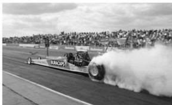
Figura 10.14 A fumaça provocada pelos pneus traseiros deste carro de corrida indica que os pneus estão deslizando sobre o piso, de modo que v_{cm} não é igual a R\omega .
