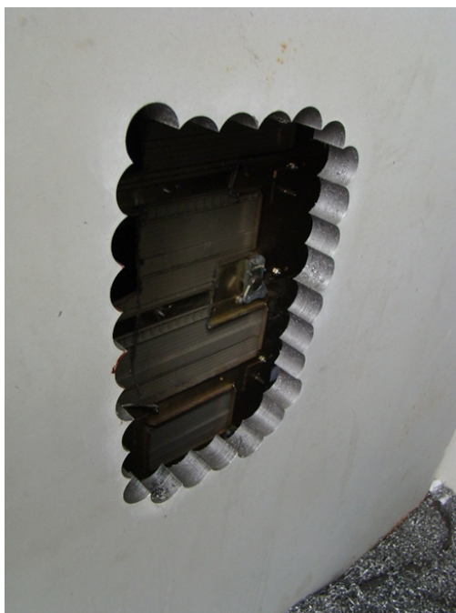
Figura 18 - Corte realizado em equipamento ATM por furadeira base magnética.
