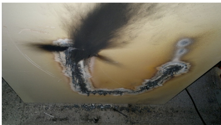
Figura 22 - Tentativa de corte em equipamento ATM por maçarico
