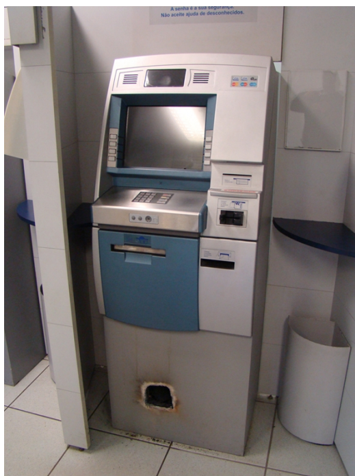
Figura 21 - Corte realizado em equipamento ATM por maçarico.
