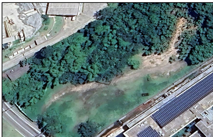
Figura 18 - Ravinamento no setor norte das encostas do sistema hidrográfico
