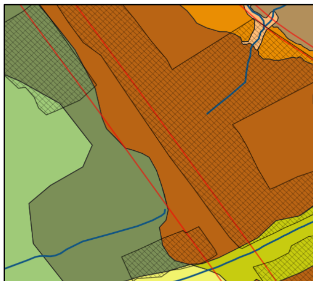
Figura 21 - Rio com leito modificado por canalização e aterro sobre o terraço colúvio-aluvionar
