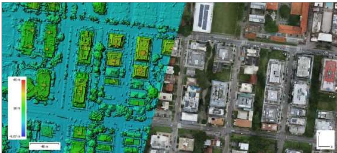
Figura 17 - Recorte de tela do software Agisoft Metashape mostrando o Modelo de Superfície (MDS) (a esquerda) e a Ortofoto (a direita) obtidos a partir do aerolevanteamento.
