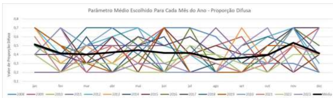
Figura 22 - Gráfico do parâmetro D (Proporção Difusa), mostrando os valores que obtiveram as menores diferenças quando comparados com valores reais ao longo de todo o período da simulação.
