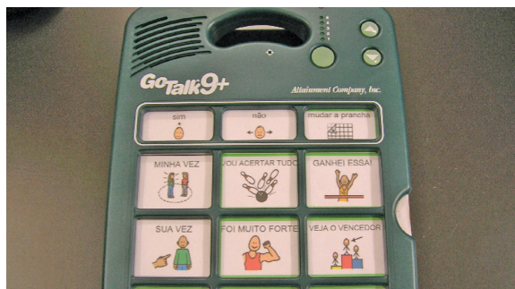
Foto 56 - Vocalizador de voz gravada com capacidade de 5 pranchas de comunicação pré programadas. O vocalizador tem 12 teclas com símbolos; quando a tecla é pressionada, ouve-se uma voz falando a mensagem correspondente ao símbolo.
