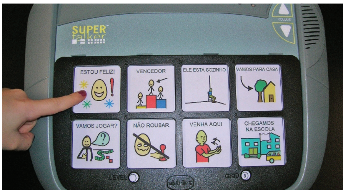
Foto 84 - Vocalizador com oito áreas de mensagens gravadas. Cada botão contém uma fala, que é ativada pelo aluno durante o desenrolar da peça de teatro.
