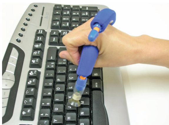
Foto 9 - Teclado convencional e órtese moldável. Aluno digita em teclado convencional utilizando uma órtese. Esta órtese é moldável, ajustada e fixada à sua mão. Na ponta da órtese, local que toca as teclas, existe uma ventosa de borracha que possibilita a aderência do recurso à tecla.
