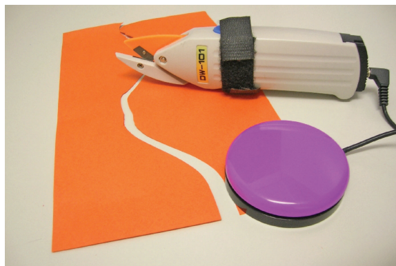
Foto 28 - Tesoura elétrica que se ativa por um botão acionador permitindo ao aluno com dificuldades motoras realizar atividades de recorte.
