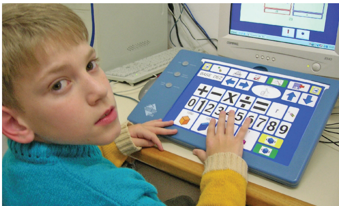
Foto 11 - Teclado expandido e programável em seu leiaute. Menino de 11 anos utilizando o teclado onde aparece uma atividade de matemática com numerais em tamanho ampliado, especialmente construída para resolver os problemas de baixa visão e de dificuldades motoras apresentadas pelo aluno.
