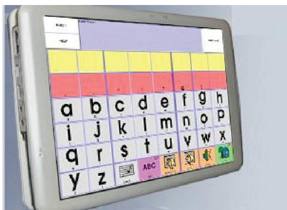
Foto 58 - Vocalizador que é um computador específico para esta função. Ele possui com um software onde as pranchas de comunicação mudam automaticamente e sua tela é ativada pelo toque direto no símbolo.
