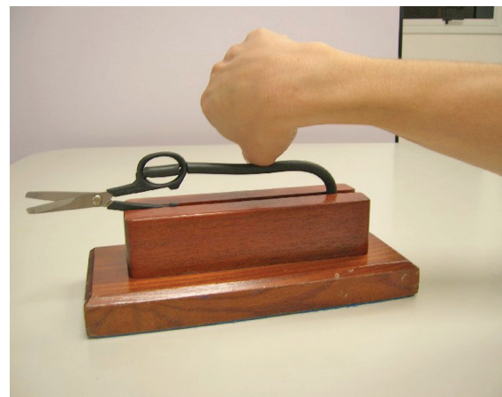
Fotos 86 e 87 - Tesoura é fixada em um suporte de madeira. O aluno bate com sua mão fechada no arco e consegue realizar o recorte.
