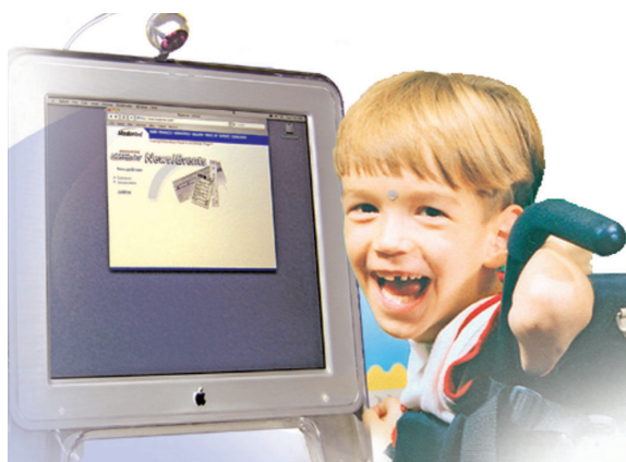
Foto 64 - Aluno ativando o computador pelo movimento da cabeça. Sobre o monitor localiza-se uma câmera que identifica um pequeno ponto luminoso colado na testa do aluno. Ao mover a cabeça, ele controla o deslocamento do cursor sobre a tela do computador. A ativação do clique acontece no momento em que o cursor parar, por um tempo determinado, na área que o aluno pretende ativar.
