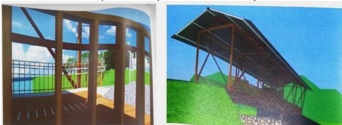
Figura 11: Detalhes do projeto do SEINFRA para substituir a antiga Ponte Alfonso Altrack com o guarda-corpo em madeira e aço corten e a vista parcial do sistema estrutural da ponte, 2017.
