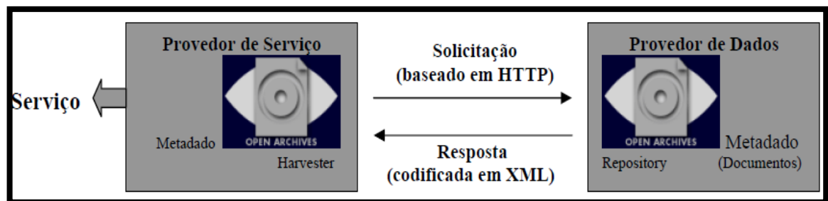
Figura 32 - Funcionamento do protocolo OAI-PMH
