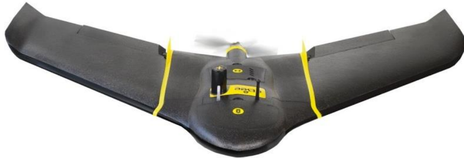
Figura 21. VANT SenseFly eBee Plus utilizado no segundo e terceiro voo na área piloto.
