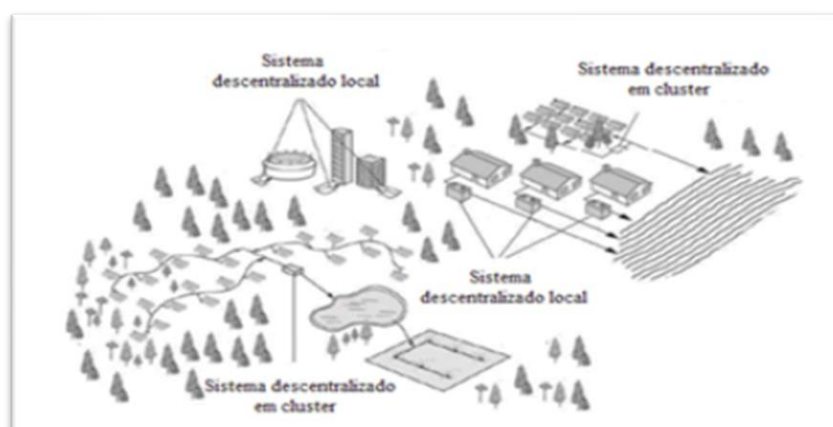
Figura 1. Sistema descentralizado Local ou em Cluster
