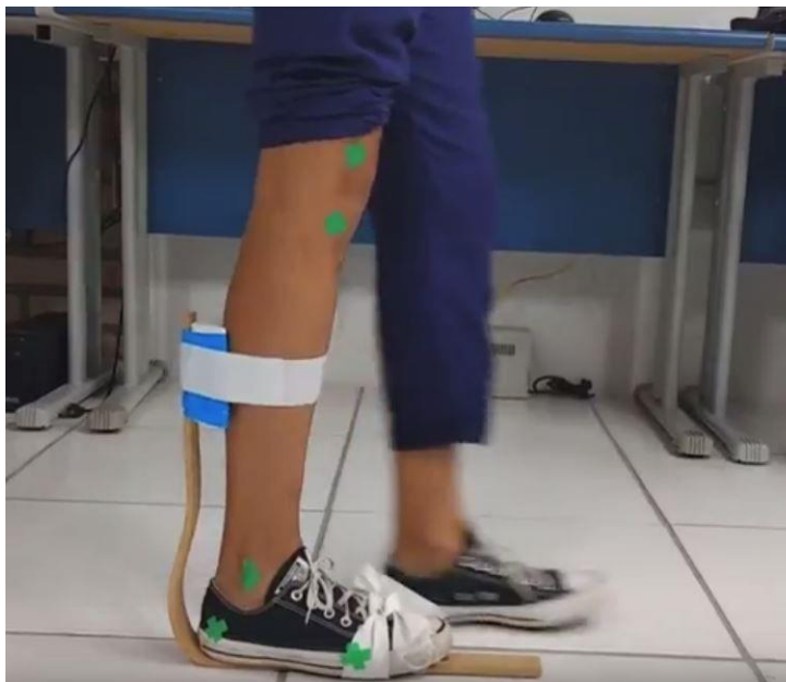
Fig. 1 Teste do primeiro protótipo da órtese de bambu
