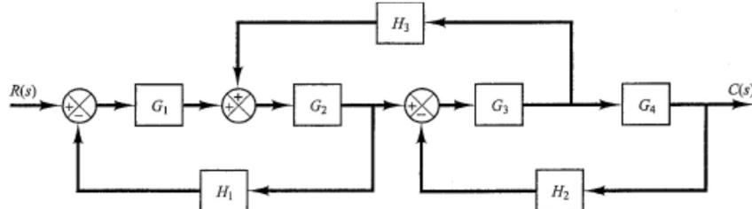
7) Reduza o diagrama de blocos abaixo para um sistema com um único bloco.
