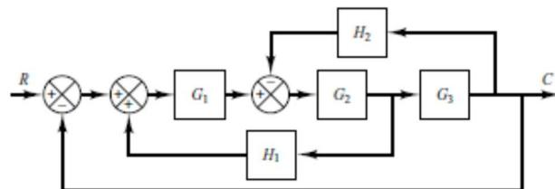
6) Reduza o diagrama de blocos abaixo para uma simples função de transferência  $T(s) = \frac{C(s)}{R(s)}$
