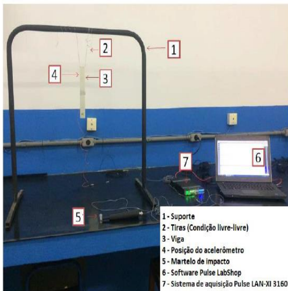
Figura 1: Representação esquemática do ensaio Fonte: Völtz (2019)
