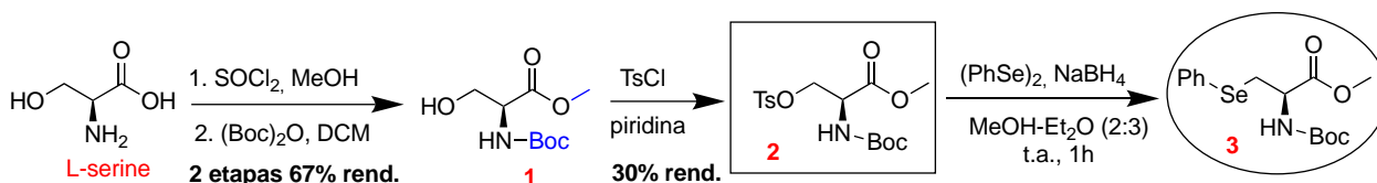
Esquema 1. Rota sintética empregada para obtenção de diferentes selenoserinas.
