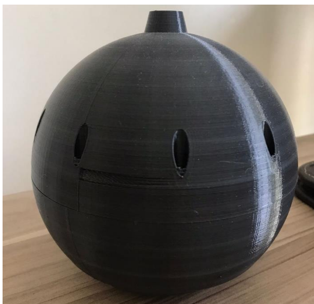
Imagem 1. Protótipo boia ondógrafo. Fonte: própria autora.
