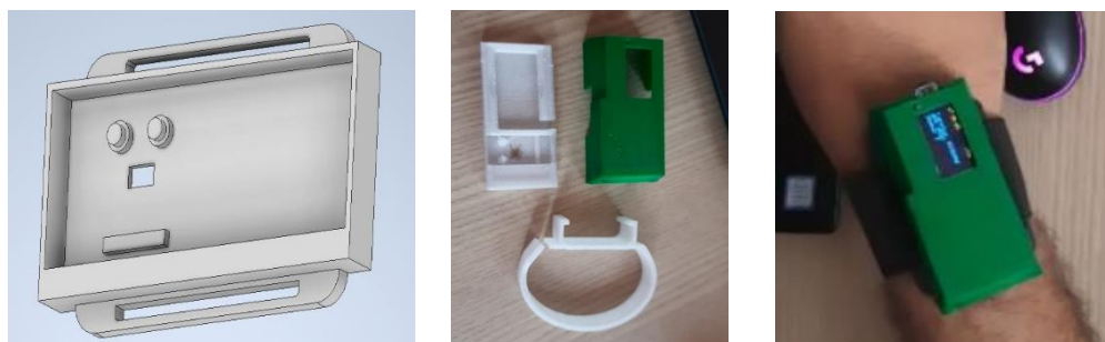
Figura 1 Protótipos desenvolvidos. A esquerda a base, no meio o primeiro modelo e a direita o segundo modelo
