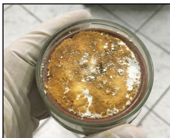
Figura 2. Formação de um filme polimérico fino (ZnOAM).
