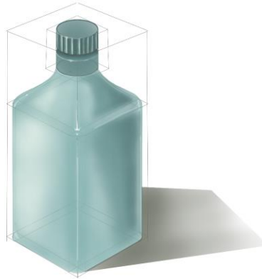
Figura 1. Construção de garrafa pelo método do cubo.
