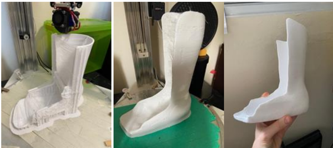
Figura 3. Etapas de impressão e acabamento da órtese tornozelo-pé
