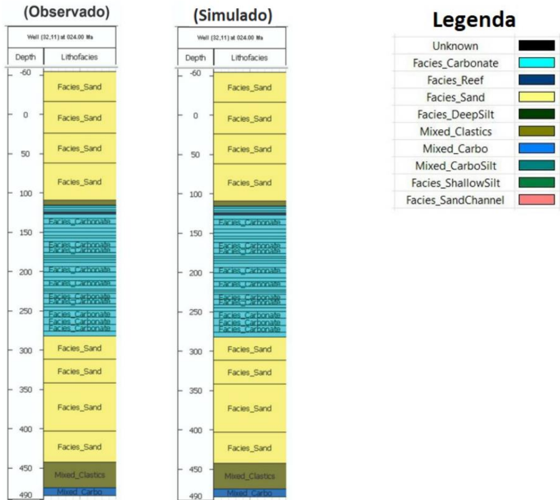
Figura 1. - Sequência geológica de dois poços iguais, observado à esquerda e simulado à direita.
