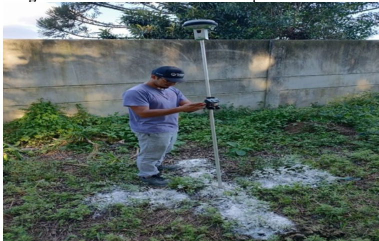
Figura 1: Coleta das observáveis dos pontos de controle.
