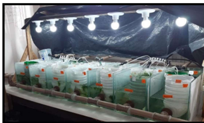
Figura 1. Sistema de recirculação experimental
