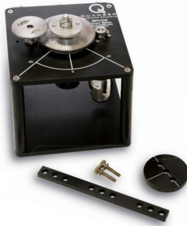
**Figura 1.** Sistema de unidade base servo rotativa Quanser
