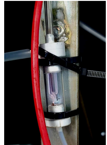
Figura 1a. Impressora 3D com o jato de plasma remoto acoplado Figura 1b. Fio de cobre com agulha de plasma em testes iniciais Figura 1c. Reator DBD onde o plasma primordial é formado
