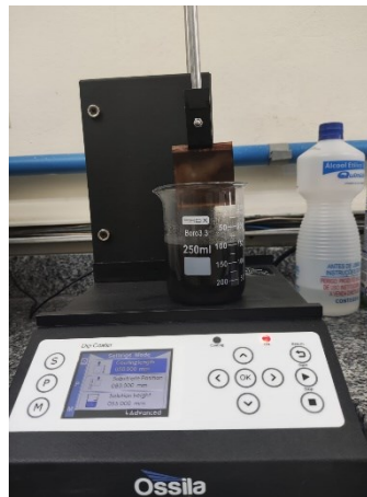
Figura 2. Deposição de óxido de grafeno em placa de cobre no Dip Coater.
