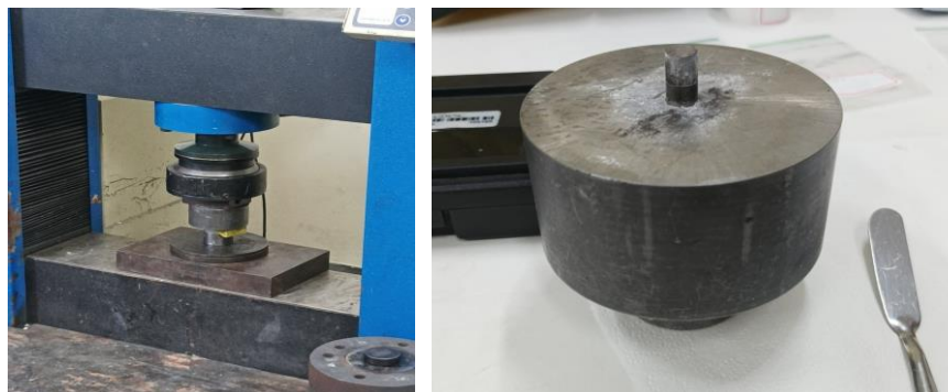
Figura 1. Processo de compactação do material.
