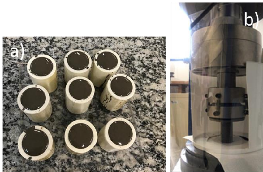
Figura 2-Copos de prova moldados (a); e Ensaio de RMC (b)
