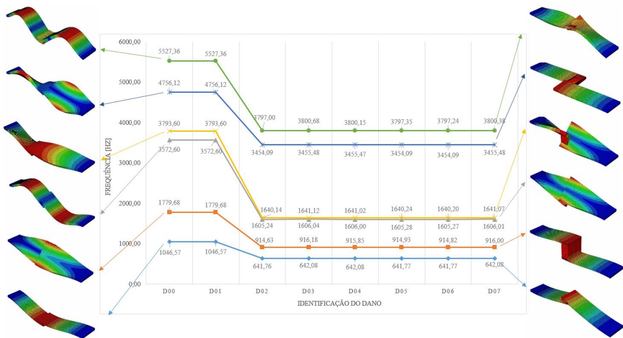
Figura 2. Análise das frequências naturais e modos de vibrar para as diferentes vigas.
