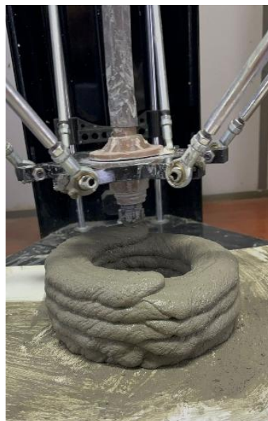
Figura 1. Impressora 3D de argamassa em funcionamento.
