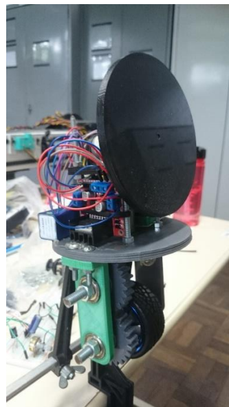
Fig. 2: Foto do protótipo montado com compensação lateral por precessão giroscópica.
