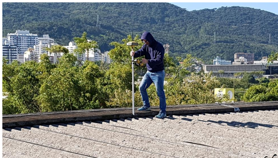
Figura 1: Levantamento topográfico do telhado da FAED - UDESC por meio de levantamento GNSS - método RTK - com o objetivo de comparar a posição planimétrica do telhado com a gerada pelo VANT. Fonte: Autor.
