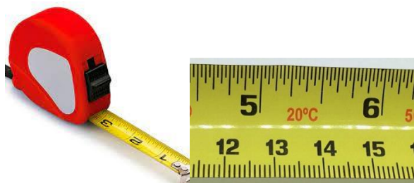
Figura 4: Trena com escala graduada em milímetros e polegadas. Algumas trenas trazem consigo gravada na fita a temperatura (em °C) e tensão (em N) de operação.
