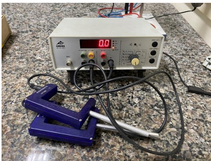
Figura 20: Contador digital com barreira luminosa.
